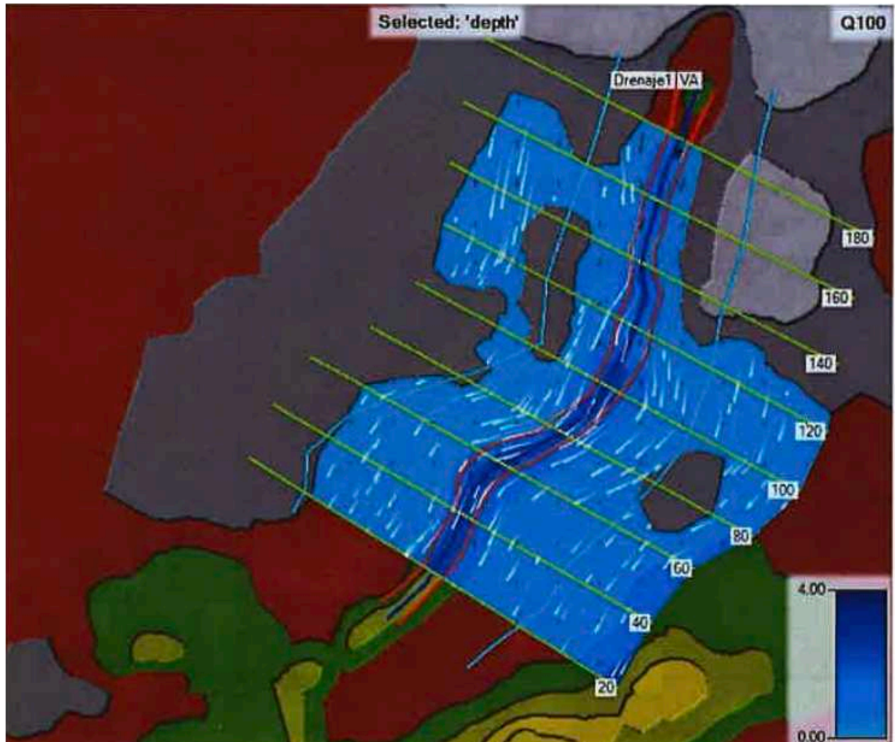
Figura No. 69 – Simulación del Área Inundada, Drenaje 1, Periodo de Retorno a 100 años
