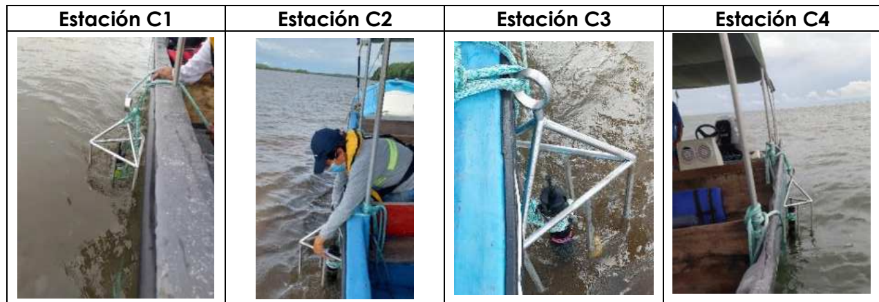
Figura 7: Instalación del ADCP en la estación C1, C2, C3 y C4 respectivamente.
