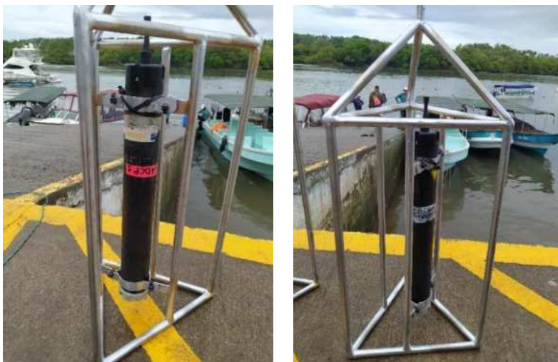
Figura 5: Correntómetros Aquadopp Profiler - ADCP. Fuente: CONSULSUA C. LTDA., 2022
